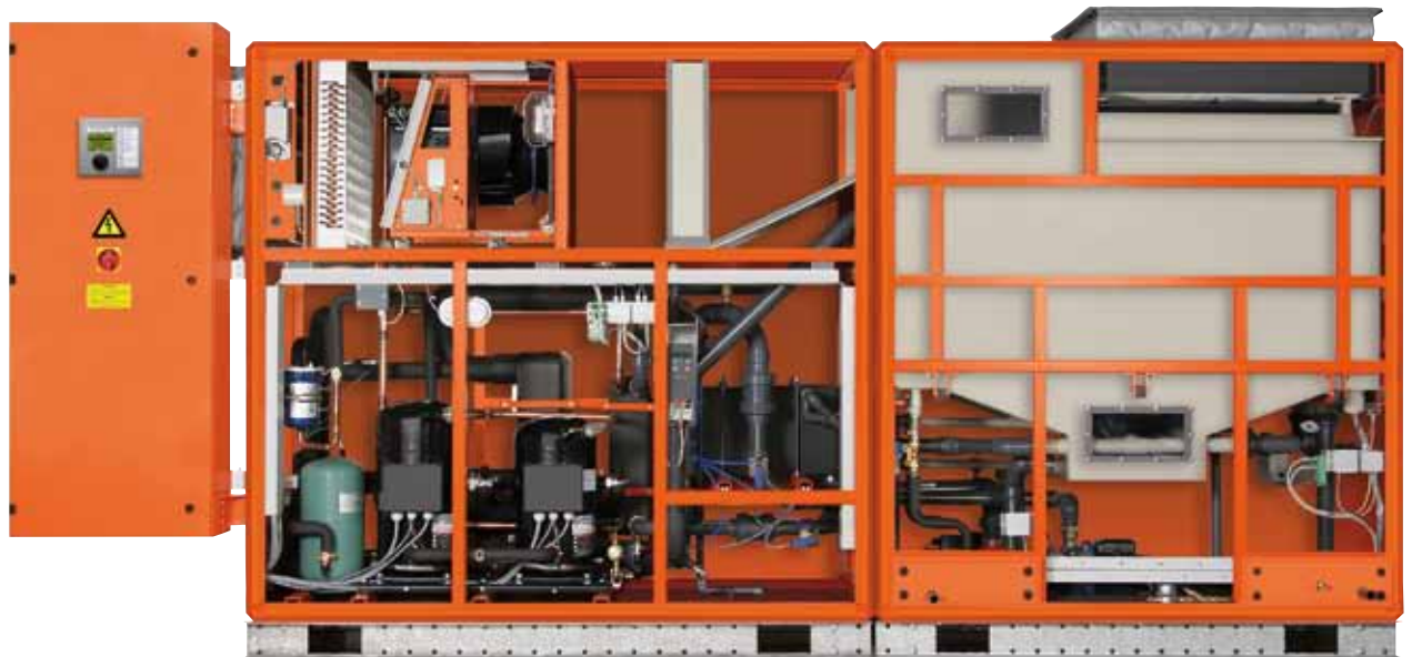
Kaltwassersatz Typ 98 mit freier Kühlung, „adiabater“ Verdunstungskühlung und integrierter Kompressions-Kälteanlage.
